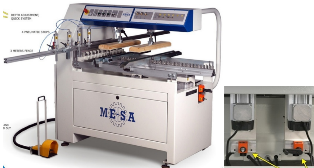
ΠΟΛΥΤΡΥΠΑΝΟ Μ63 ΖΚΕΦΑΛΩΝ ΜΕ 63 ΑΥΤΟΜΑΤΑ ΤΡΥΠΑΝΙΑ
